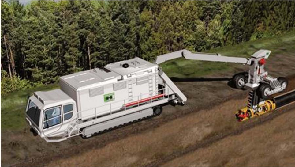
Pipe Express mit Oberflächenfahrzeug Quelle: Herrenknecht
